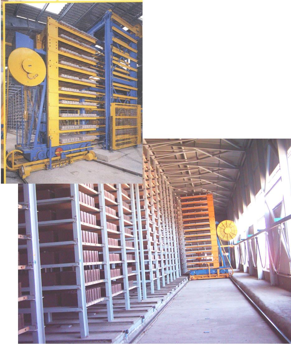
Şekil 13. Bimsblokların kütüphanelerine robot yardımı ile taşınması.
