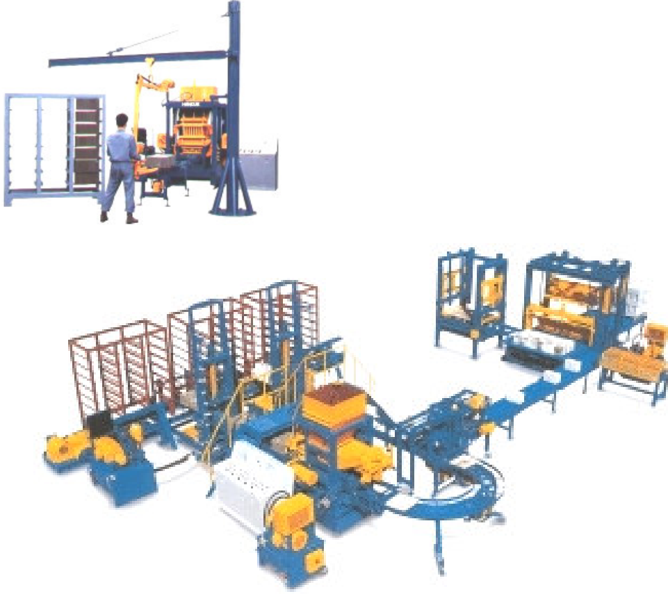
Şekil 16. Yarı otomasyonlu bimsblok üretim sistemi sembolik görünümü.
