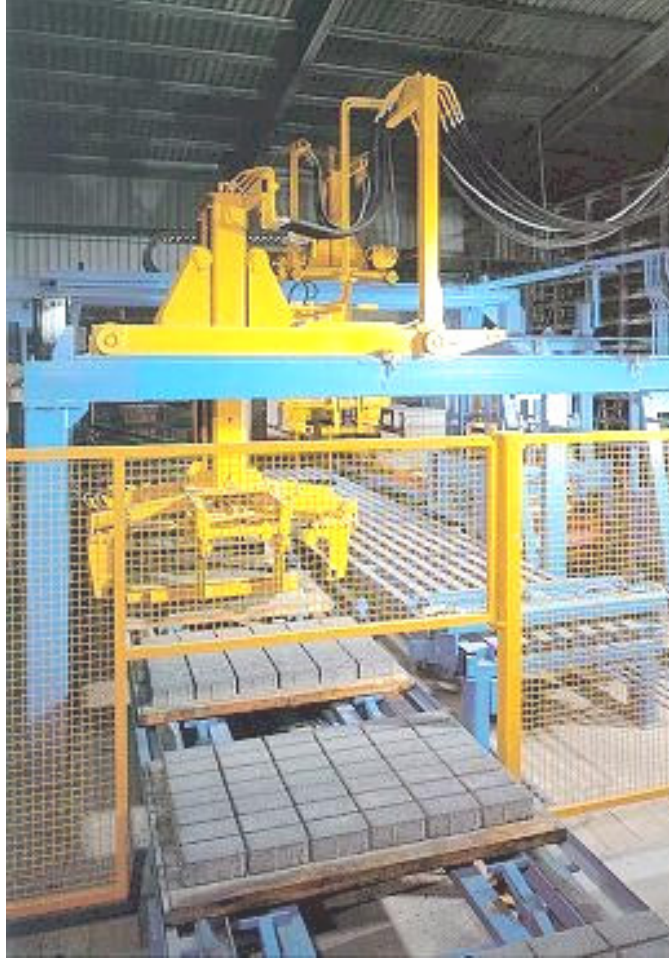
Şekil 14. Bimsblokların kütleme sonrası paketlenmesi.
