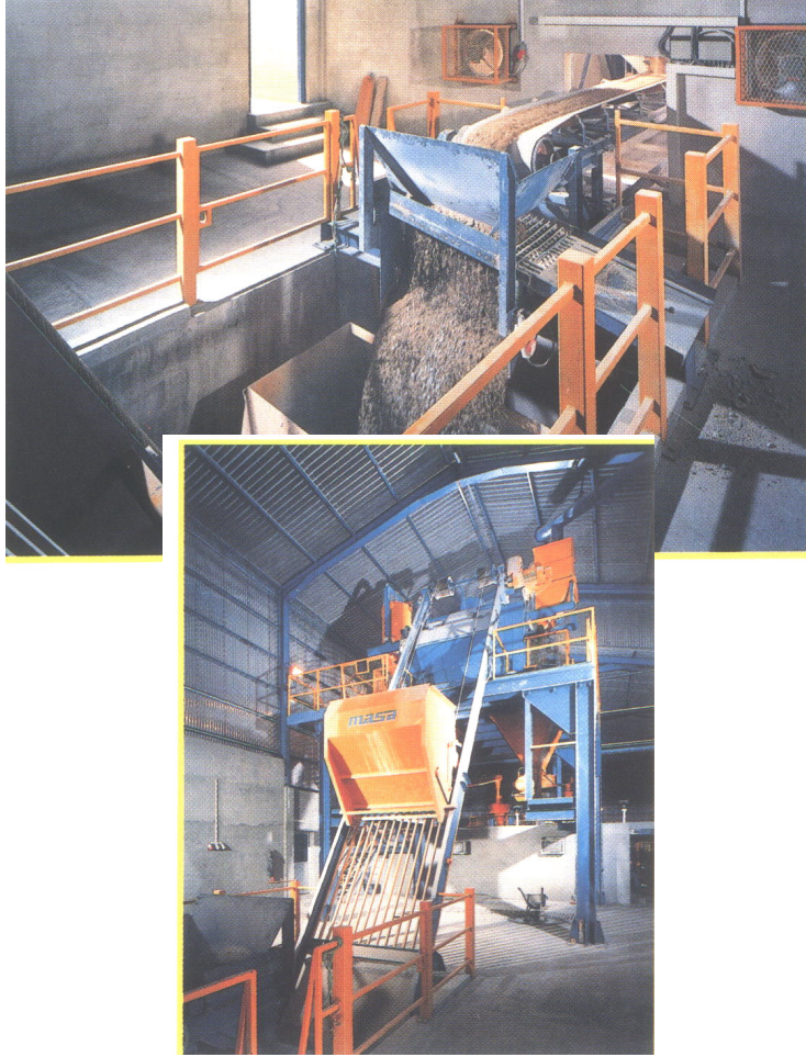
řekil 10. Silolardan hammaddenin boşalması ve miksere yklenmesi.
